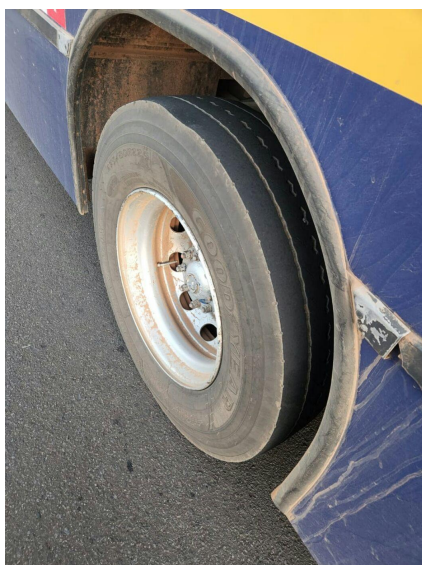
Pneu em condições precárias
